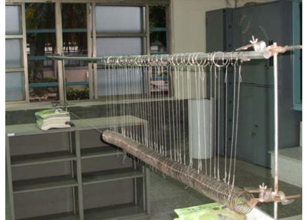
(二)實驗裝置：利用鐵架架起鐵管，將鐵環穿過鐵管，取適當的彈簧間格，用等長的棉線綁於鐵環上（約綁 50 個），懸吊彈簧（如下）。
